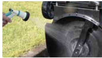
ด้านในของแท่นตัดสามารถล้าง ทำความสะอาดได้
