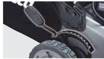
ความสูงของการตัดสามารถปรับได้ ด้วยแฮนด์
